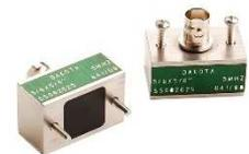
**Membrane** - sonda s mäkkou pružnou membránou, ktorá zvyšuje kontakt medzi sondou a materiálom s drsným povrchom. K dispozícii je aj sonda s vysoko výkonným kompozitným kryštálom pre lepšiu penetráciu.
